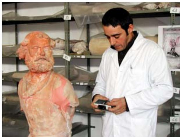
Medição dos níveis de UV com medidor de UV
