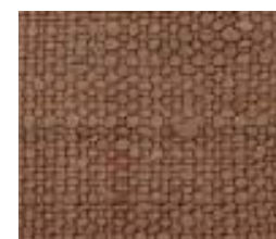
Fig. 3 - Tafetá de seda tussah a usar na consolidação do tapete (redução: 72fios/cm 2 ).
